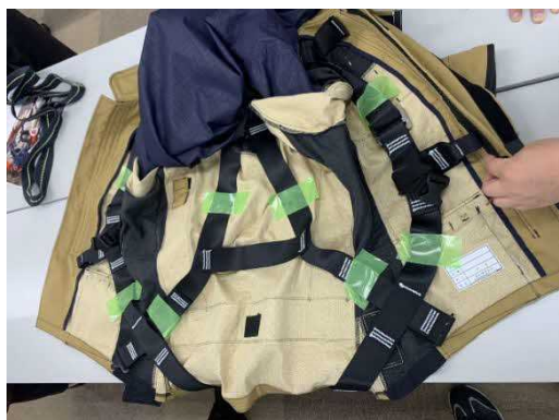
写真3 フルハーネスを上衣内部への固定状況
