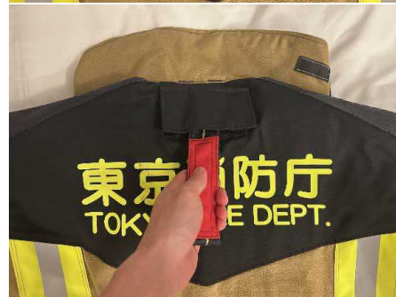
写真 17 牽引救出装置（DRD）
