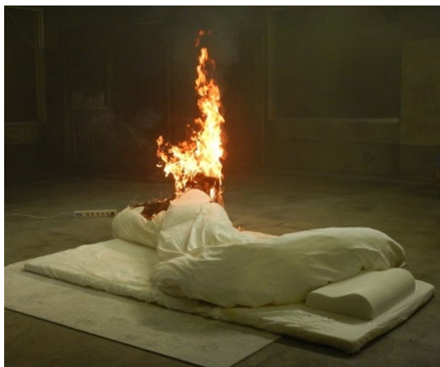
写真1 電気ストーブに布団が接触し出火した様子 （実験写真）
