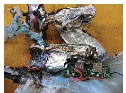
写真 1-3 潰れて燃えた充電式電池
