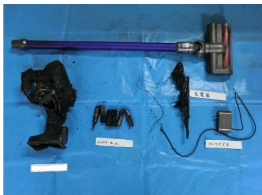
写真 2-1 焼損した掃除機の状況
