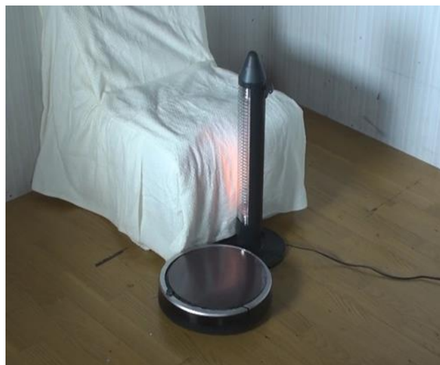
写真2 電気ストーブがロボット掃除機に押されて ソファに接触した様子 (実験写真)
