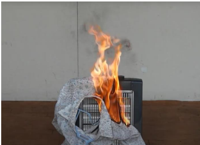
写真2 電気ストーブの上に洗濯物が落下し出火した様子（実験写真）
