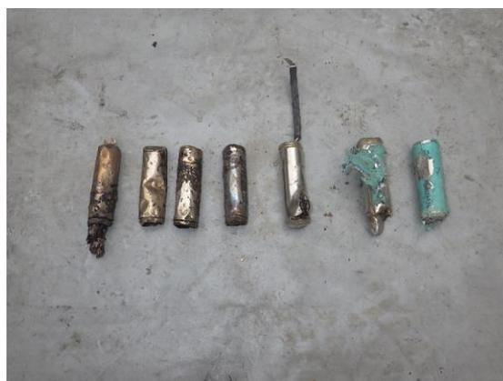
写真8 リチウムイオン電池の状況
