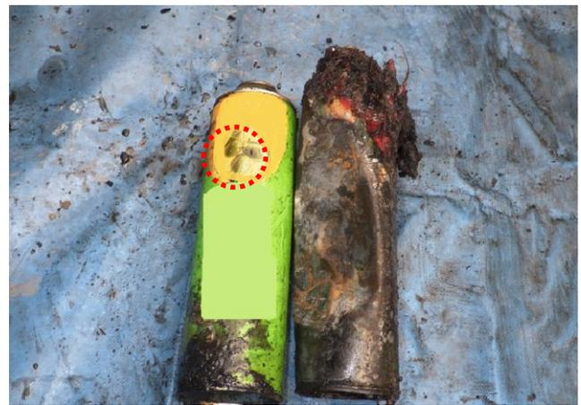
写真4 穴開けをしたスプレー缶の状況
