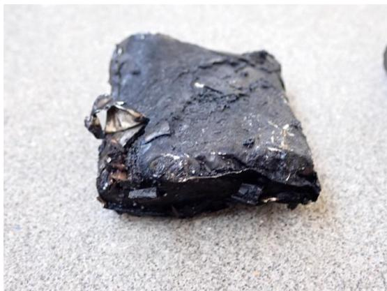
写真6 焼損したモバイルバッテリーの状況
