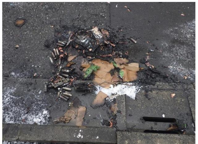
写真12 ポータブル電源の焼損状況
