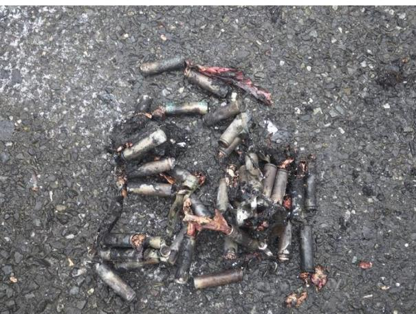
写真13 リチウムイオン電池の焼損状況
