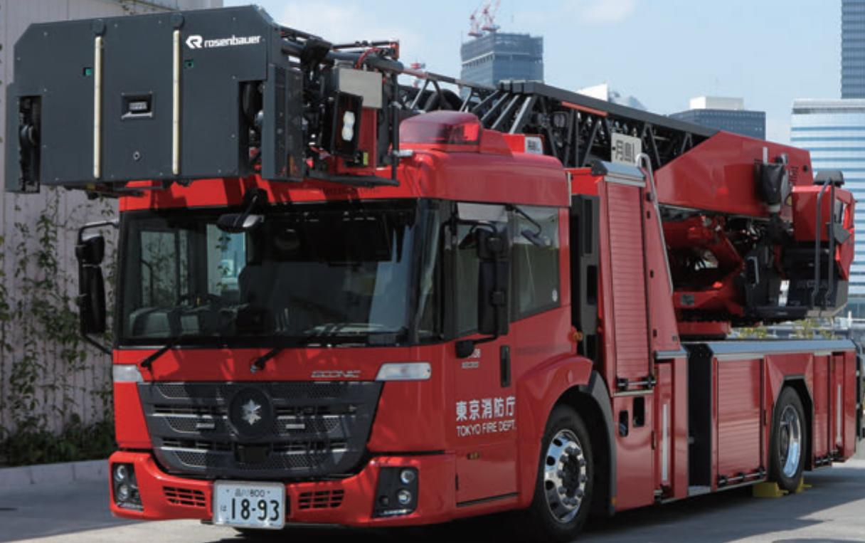
高さ制限の低い高架下を安全に通過するため、全高が 3.2 m 以下に抑えられたこのはしご車は、はしご先端が屈折する構造になっており、車いすの要救助者でもバスケットへの乗降が可能です。
