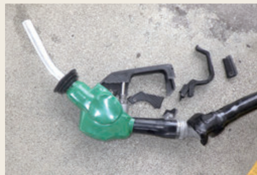
▲破損した給油ノズル
