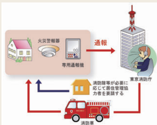
■ 図表2-4-17 住宅火災直接通報のしくみ
