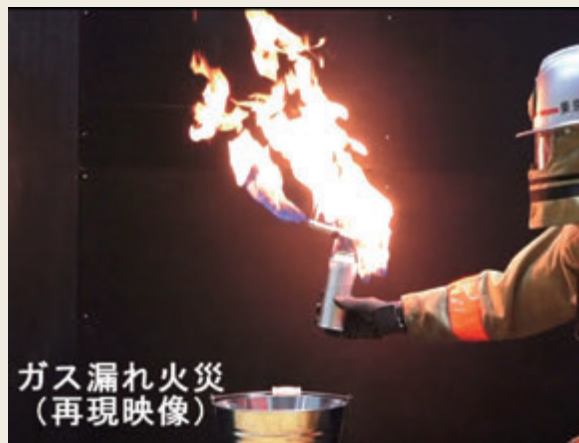
▲ ガスストーブバーナーに起因した火災の再現実験
