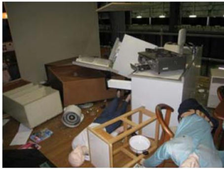
図 3-1-11 集合住宅のキッチンの状況（左：家具転倒対策なし，右：対策あり）（榎田・他，2009） 1)
