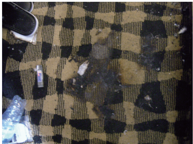
写真 6-4-4 ライター及びカーペットの焼損状況
