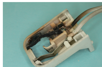
写真 6-3-5 ソケット内部の焼損状況
