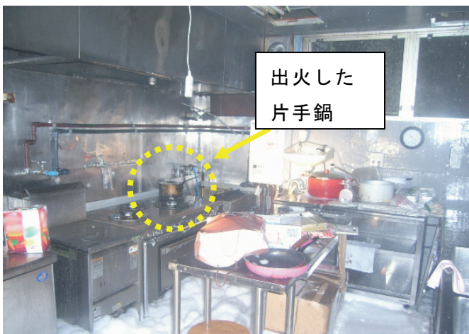
写真 7-3 出火した厨房の状況
