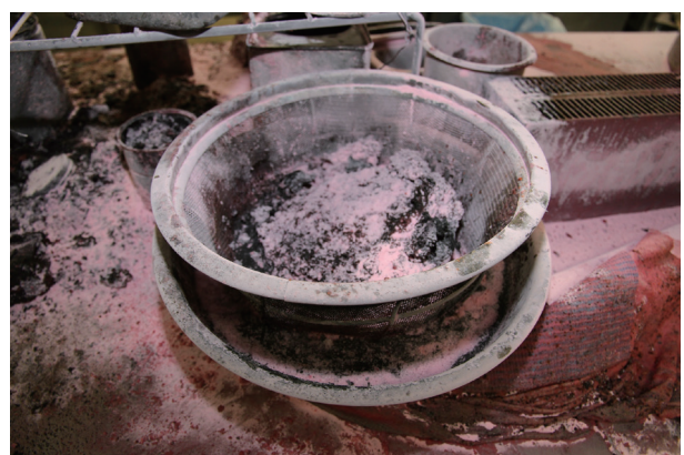
写真 6-6-4 揚げかすの焼損状況
