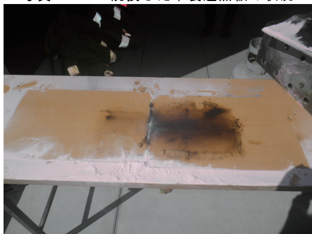
写真 2-7-2 焼損した木製遮熱板の状況
