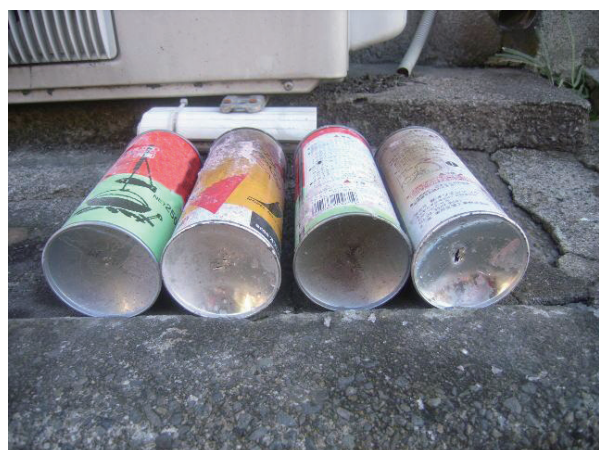
写真 3-4-4 穴開けをしたカセットボンベ
