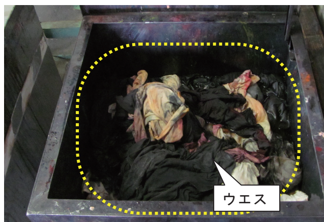
写真 6-12-4 使用済みウエスの焼損状況
