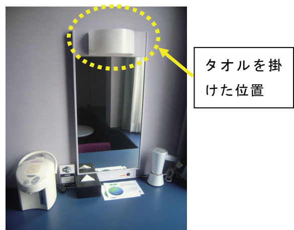
写真 6-10-5 焼損した照明付き鏡（同型品）
