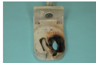
写真 6-3-5 ソケット内部の焼損状況
