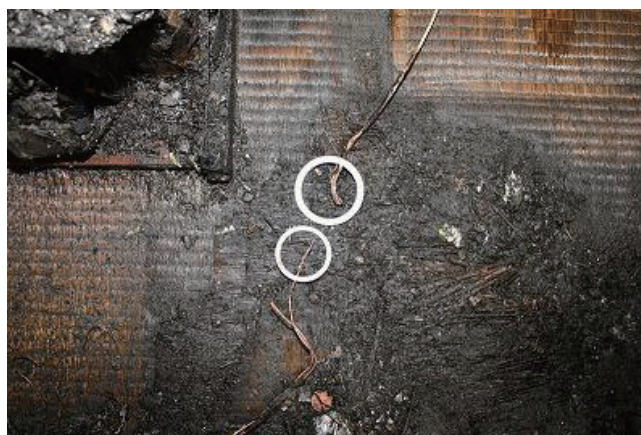
写真 4-5 コードの短絡痕の状況
