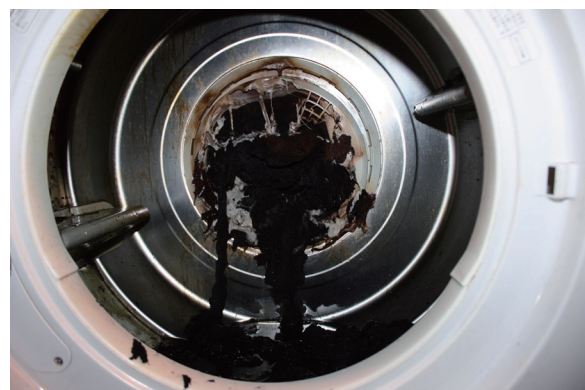
写真 3-2-5 乾燥機の焼損状況
