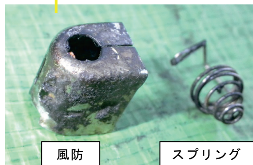
レール上で発見されたライター焼損物
