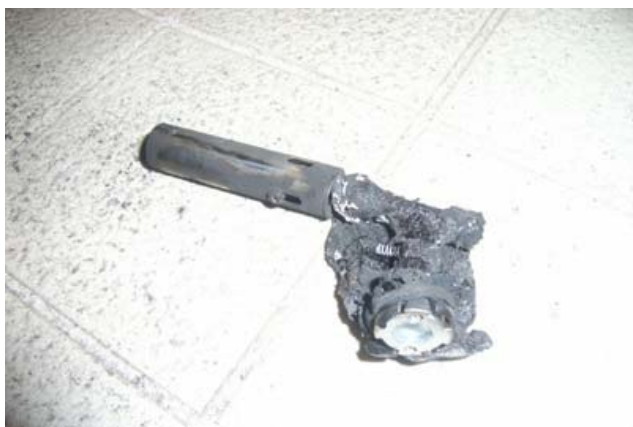
写真 3-3-4 焼損したバーナ本体
