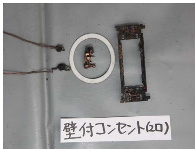
写真 6-1-5 コンセントと差込みプラグの状況
