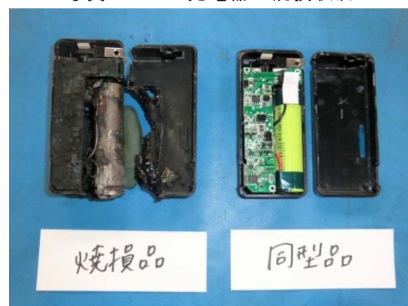
写真 3-5-4 充電器の焼損状況
