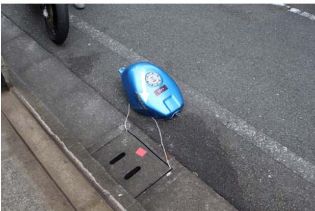
写真 3-2-3 燃料タンクからの流出状況
