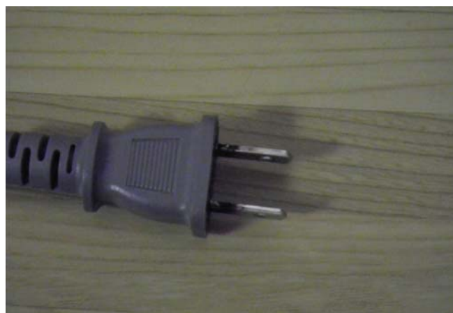
写真 2-6-2 プラグの焼損状況
