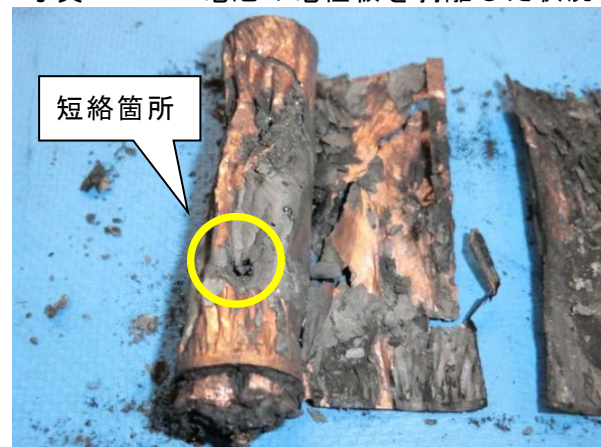
写真 3-5-5 電池の電極板を剥離した状況
