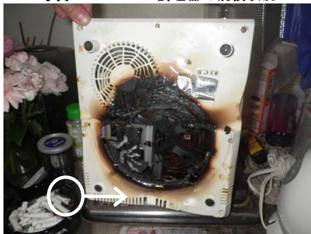
写真 3-5-2 IH調理器の焼損状況
