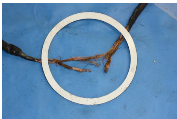
写真 6-8-5 短絡したコードの状況
