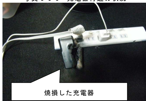
写真 3-5-3 充電器付近の状況
