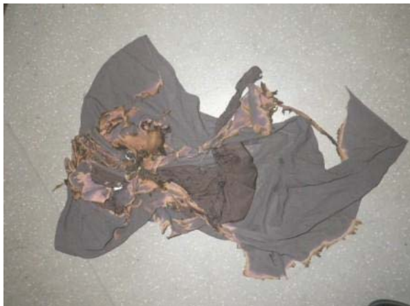
写真 5-3-2 焼損したストールの状況
