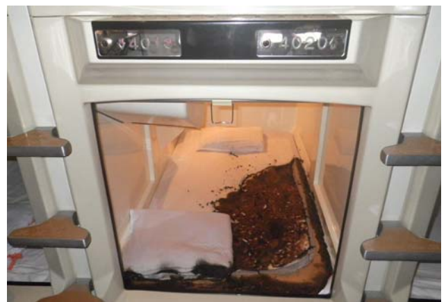
写真 6-4-4 マットレスの焼損状況
