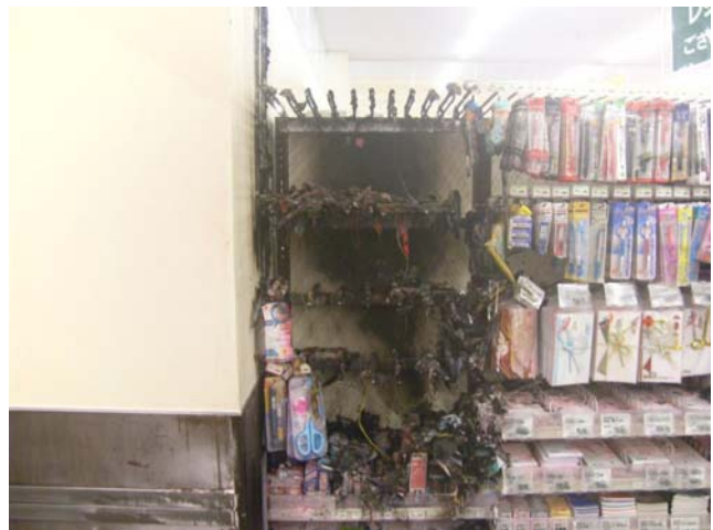
写真 6-3-4 商品陳列棚の焼損状況
