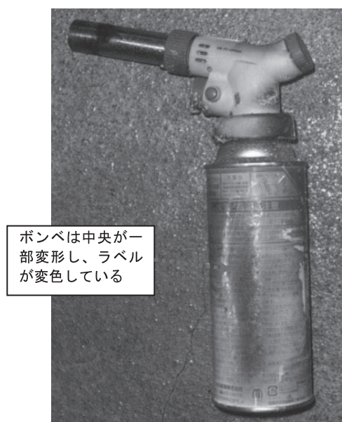
写真5 トーチバーナーの状況1
