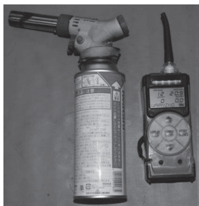
写真7 ガス漏れ確認
