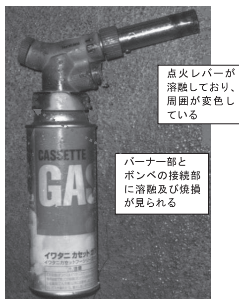
写真6 トーチバーナーの状況2
