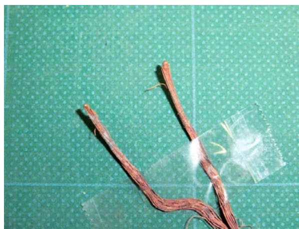
写真 6-8-2 コード短絡の状況
