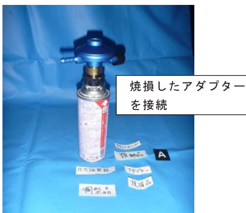
写真 3-3-4 ボンベと圧力調整器の接続状況
