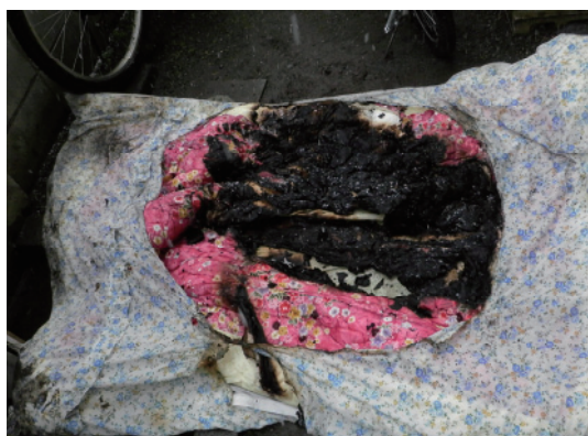
写真 2-6-4 焼損した掛布団の状況
