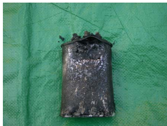
写真 6-7-2 低圧進相コンデンサの状況
