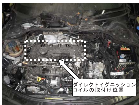
写真 6-13-1 エンジンルーム内の状況
