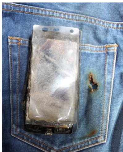
写真 2-6-1 焼損した衣類とスマートフォン
