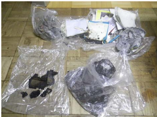
写真 6-6-4 出火したごみの焼損状況
