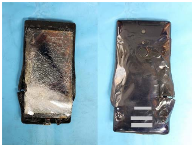
写真 2-6-2 焼損したスマートフォンの状況
