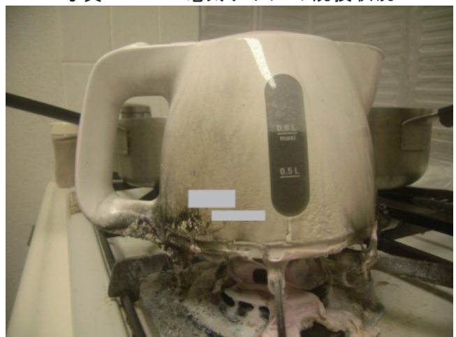
写真 2-7-4 電気ケトルの焼損状況
