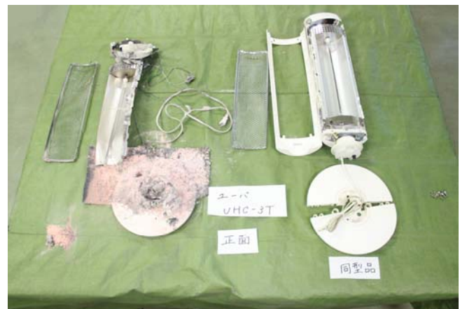
写真 3-5-4 カーボンヒータの焼損状況
