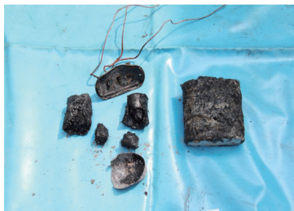
写真 6-3-2 焼損した低圧進相コンデンサ
