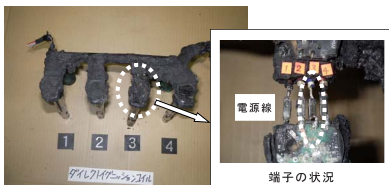
写真 6-13-2 取り外したダイレクトイグニッションコイルの状況
