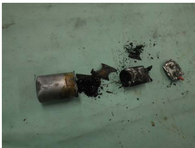
写真 6-5-2 コンデンサを分解した状況
