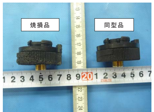
写真 3-3-5 アダプターの変形状況
