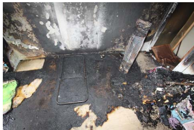
写真 2-3-2 ハロゲンヒータの状況（復元）
