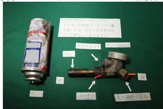
写真 3-5-2 ボタントーチバーナの焼損状況
