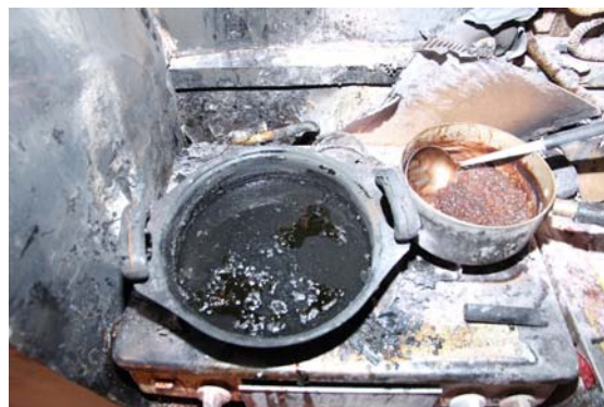
写真 3-1-2 ガステーブルの焼損状況
