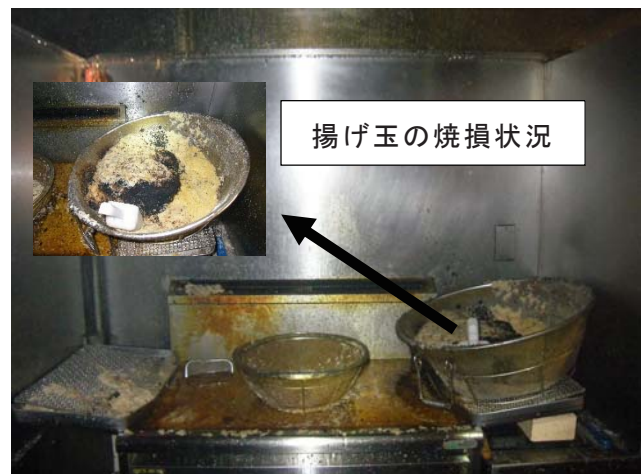
写真 6-7-4 フライヤ付近の揚げ玉の状況
