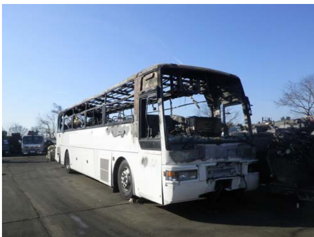
写真 6-13-3 車両の焼損状況
