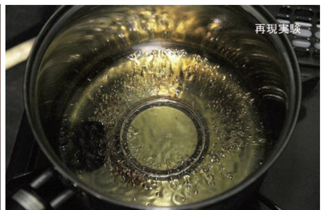
写真 3-3-1 加熱後片手鍋の中身を確認し出火 写真 3-3-2 オイル加熱状況（ガスの気泡多数）
