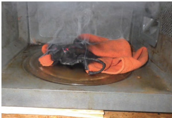
写真 5-1-2 焼損した布巾の状況
