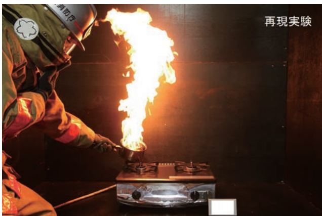
写真 3-3-1 加熱後片手鍋の中身を確認し出火 写真 3-3-2 オイル加熱状況（ガスの気泡多数）
