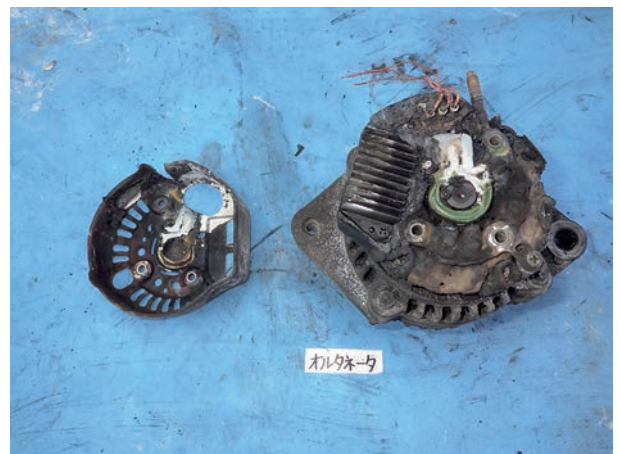
写真 6-13-2 オルタネータの焼損状況
