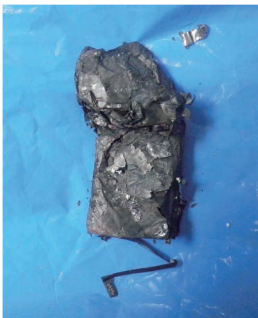
写真 2-6-4 焼損したスマートフォンの状況
