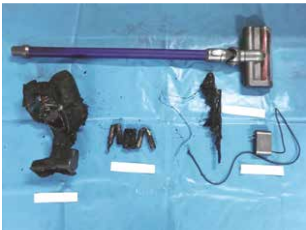
写真 6-3 焼損したコードレス掃除機の状況
