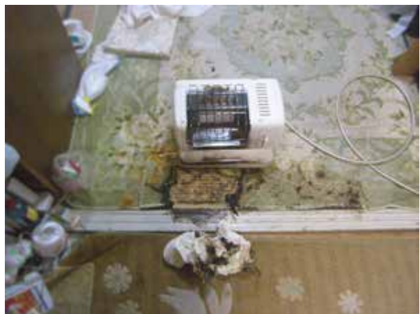
写真 19-2 ガsstーブ周辺の焼損状況
