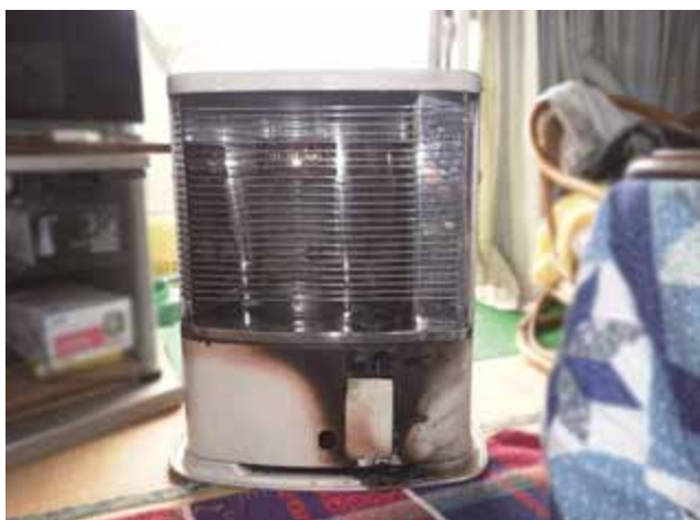
写真 8-1 石油ストーブの焼損状況
