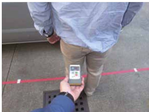
写真 29-5 帯電測定状況
