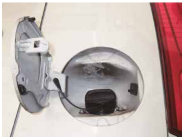
写真 29-4 給油口に付着した煤
