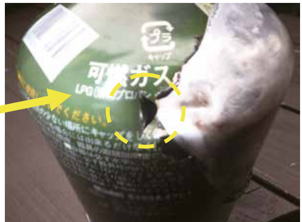
写真 7-4 カートリッジの破損状況
