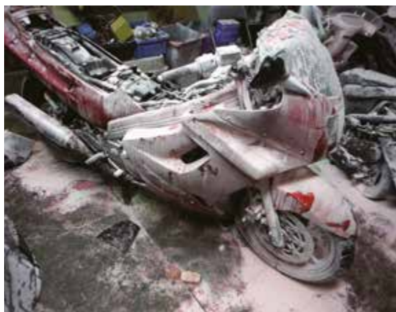
写真 10-1 焼損したオートバイ
