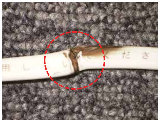
写真 27-3 コードの焼損状況
