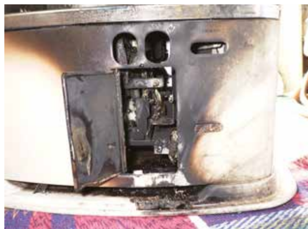
写真 8-2 操作扉内部の焼損状況
