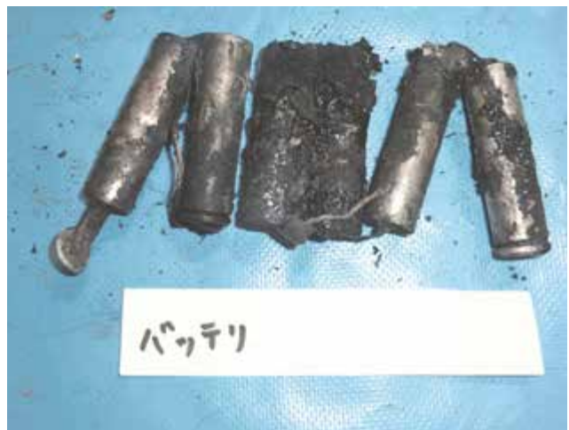
写真 6-4 焼損した純正品でない バッテリーパックの状況
