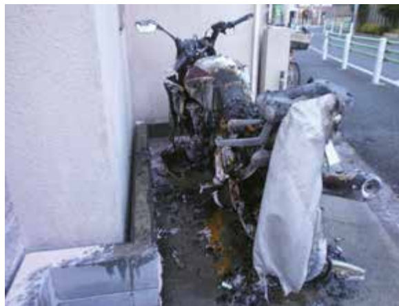
写真 1-2 焼損したボディカバー
