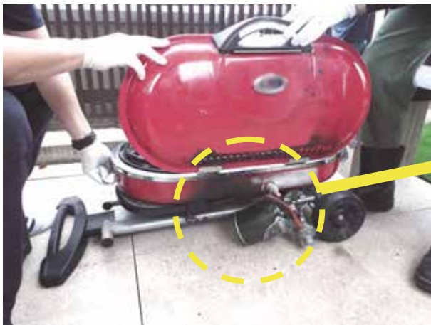
写真 7-3 バーベキューグリルの焼損状況
