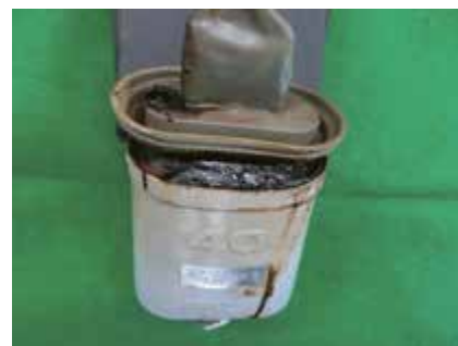
写真 26-3 進相コンデンサの焼損状況
