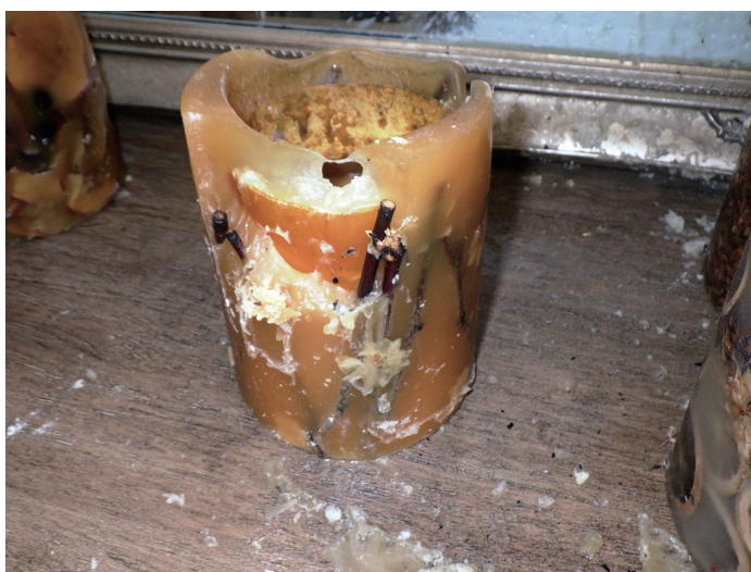
写真 5-2 アロマキャンドルの焼損状況
