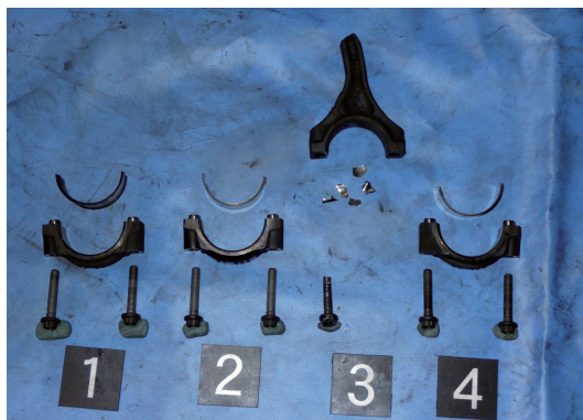
写真 30-2 コンロッドとメタルの破損状況
