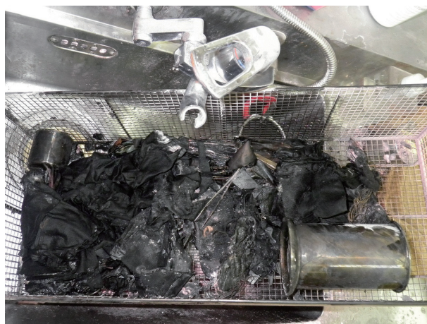
写真 23-2 医療器具等の焼損状況
