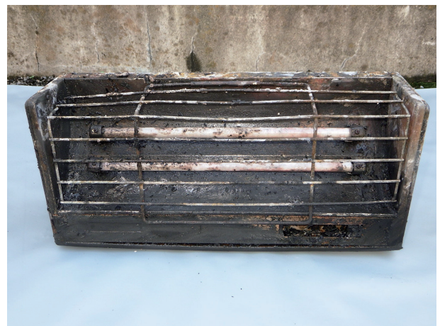
写真 14-2 焼損した電気ストーブの状況
