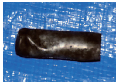
写真 29-4 火源となった リチウムイオン電池
