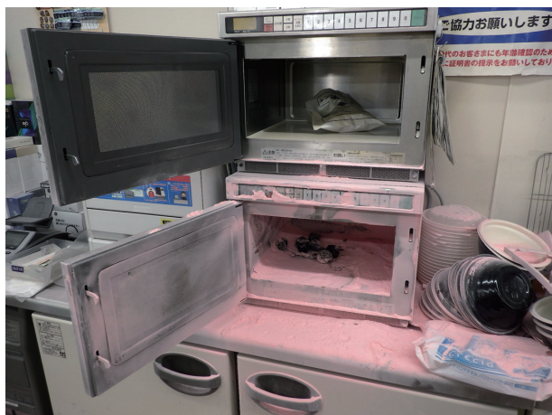
写真 21-3 焼損した電子レンジの状況
