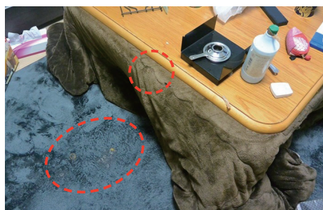
写真 8-3 アルコールこんろの使用状況（赤丸は焼損箇所）
