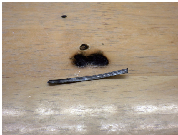
写真 24-4 机の焼損状況 2
