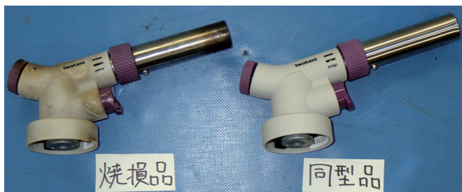
写真 13-1 ボタンガストーチバーナの焼損状況
