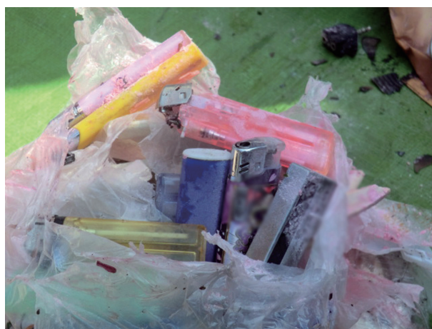
写真 4-2 焼損したごみくずとライターの状況
