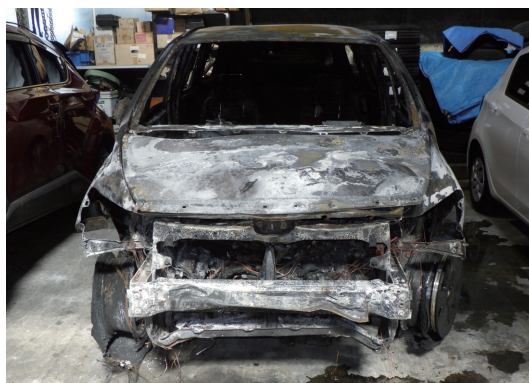
写真 30-1 車両の焼損状況
