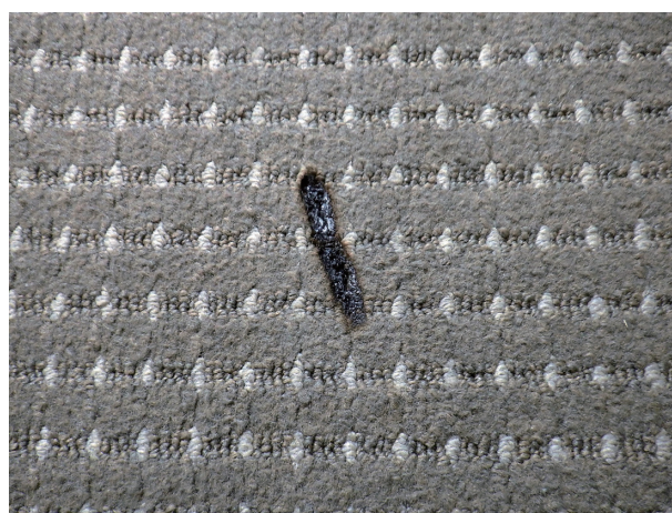
写真 22-4 カーペットの焼損状況
