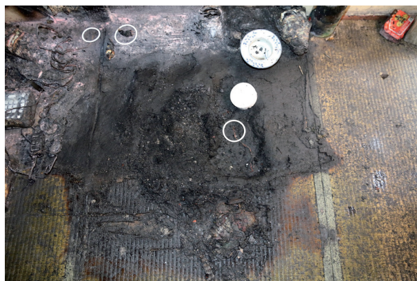
写真 2-4 たばこの火種による焼損状況
