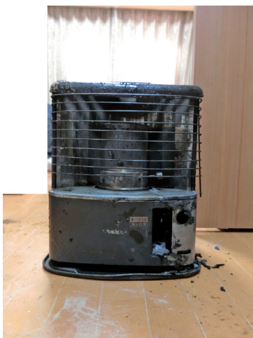
写真 8-1 石油ストーブの焼損状況
