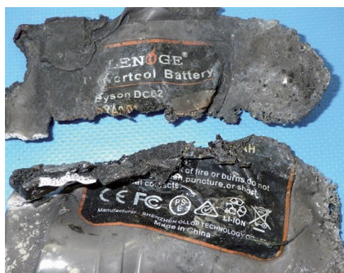
写真 6-4 バッテリーパックの焼 損状況
