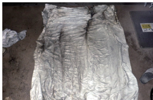
写真 18-2 防災カーテンの焼損状況
