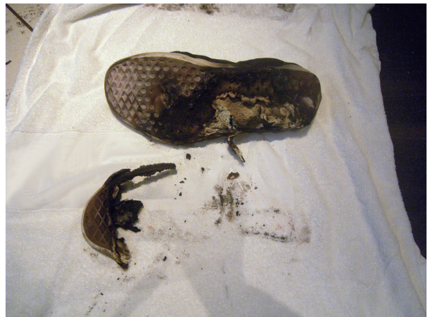
写真 22-2 焼損した靴の状況
