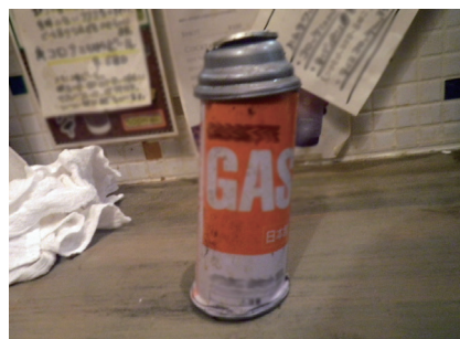
写真 12-3 カセットボンベ の破損状況
