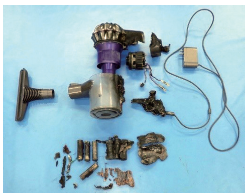
写真 6-3 コードレス掃除機の 焼損状況
