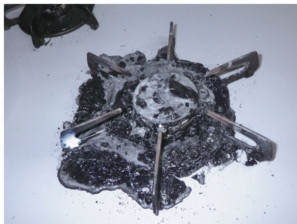
写真 15-2 焼損した保温ポットの状況
