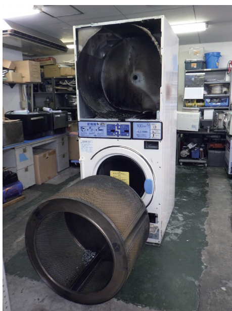
写真 7-3 衣類乾燥機の焼損状況
