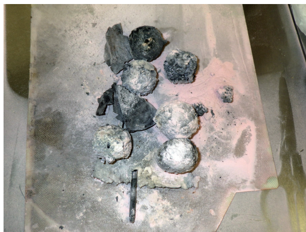
写真 21-4 加熱していた冷凍食品の焼損状況
