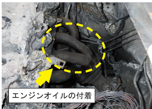
写真 30-3 排気管の状況
