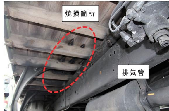
写真 30-1 荷台下部の焼損状況
