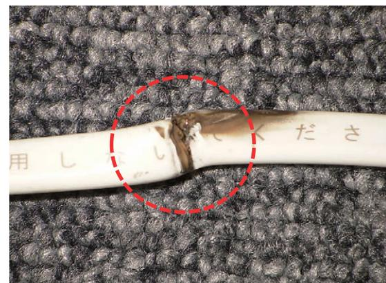
写真 27-3 コードの焼損状況
