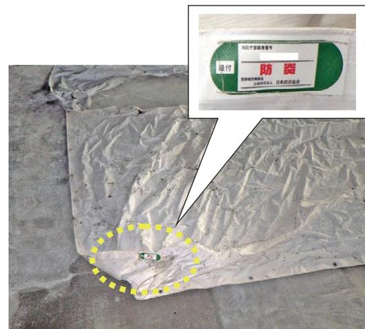
写真 18-2 防災シートの焼損状況
