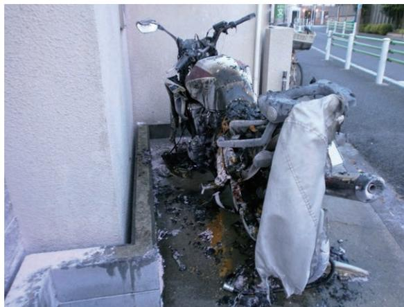
写真 1-2 焼損したボディカバー
