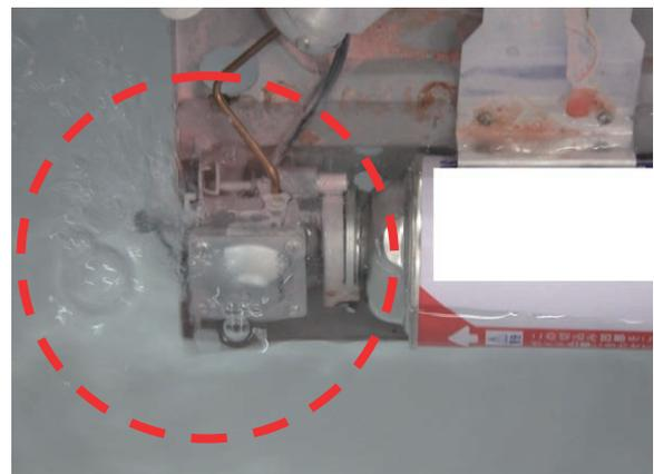
写真 11-2 水中に漏れたLPガスの気泡
