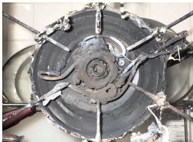
写真 15-2 焼損した電気ケトル（底面）の状況
