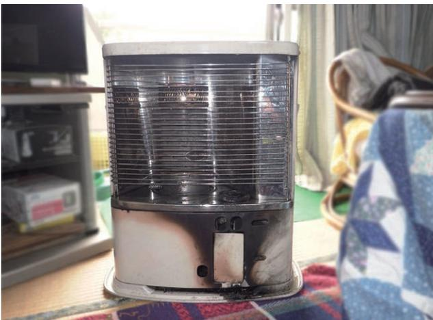
写真 8-1 石油ストーブの焼損状況
