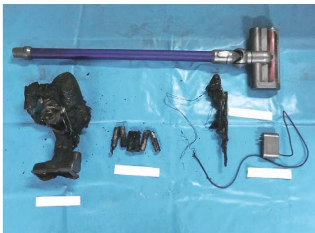
写真 6-3 焼損したコードレス掃除機の状況
