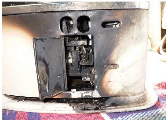
写真 8-2 操作扉内部の焼損状況
