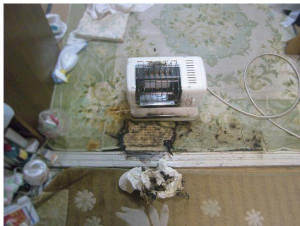
写真 19-2 ガストーブ周辺の焼損状況
