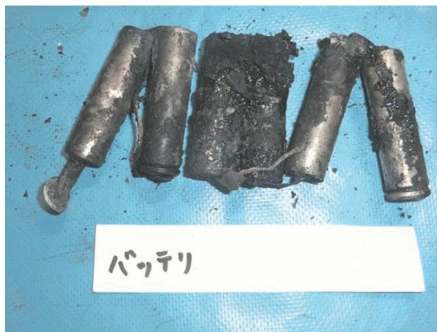
写真 6-4 焼損した純正品でない
