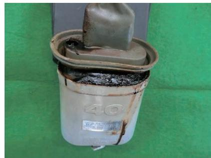
写真 26-3 進相コンデンサの焼損状況
