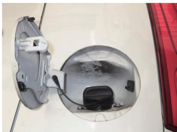
写真 29-4 給油口に付着した煤
