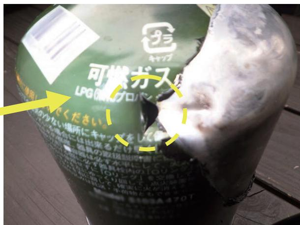
写真 7-4 カートリッジの破損状況
