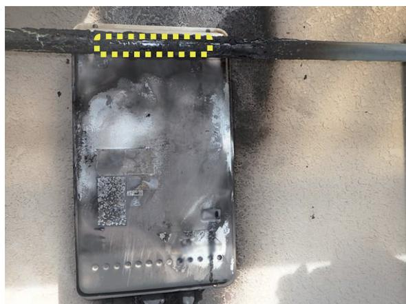
写真 7-2 給湯器の焼損状況
