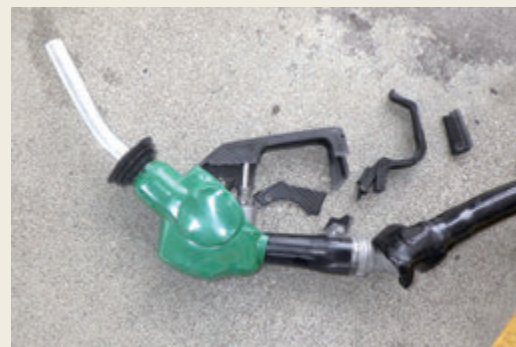
▲破損した給油ノズル
