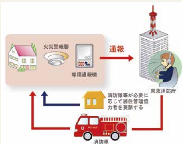
■ 図表2-5-17 住宅火災直接通報のしくみ
