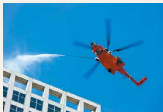
▲ 高層ビル火災を想定した、放水ブーム式消火装置での消火活動訓練
