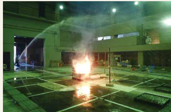
▲ 発泡器具の発泡性能、消火性能等の検証
