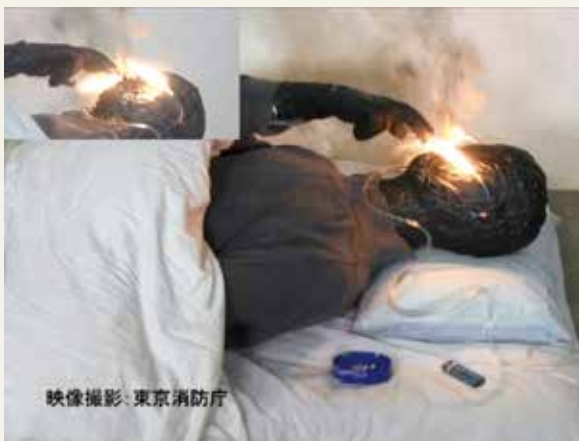
▲ 酸素吸入器に起因した火災の再現実験
