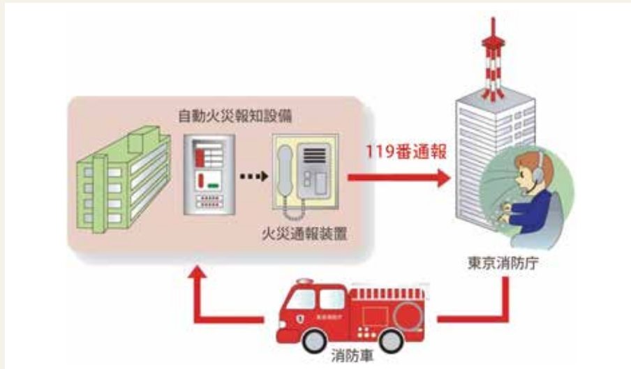
■ 図表2-6-13 事業所火災直接通報のしくみ
