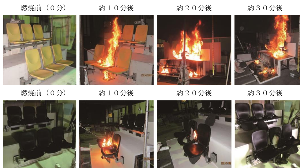
図 6-1 A社で開発している椅子の検証実験の様子
