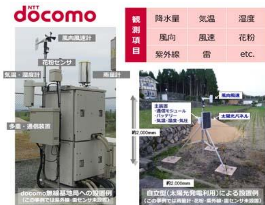
図 3-1-1 NTT ドコモの設置している環境センサー（出典：NTT ドコモ HP）
