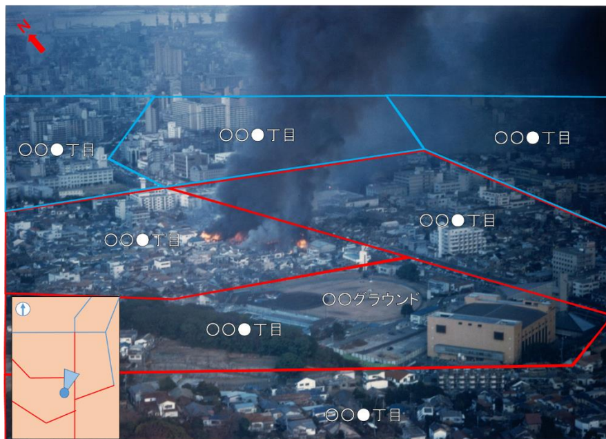
図 3-1-4 上空からの映像で地点を特定できるシステムのイメージ (ヘリの GPS 情報や高度、カメラの角度から地図情報を合成するシステムのイメージ)
