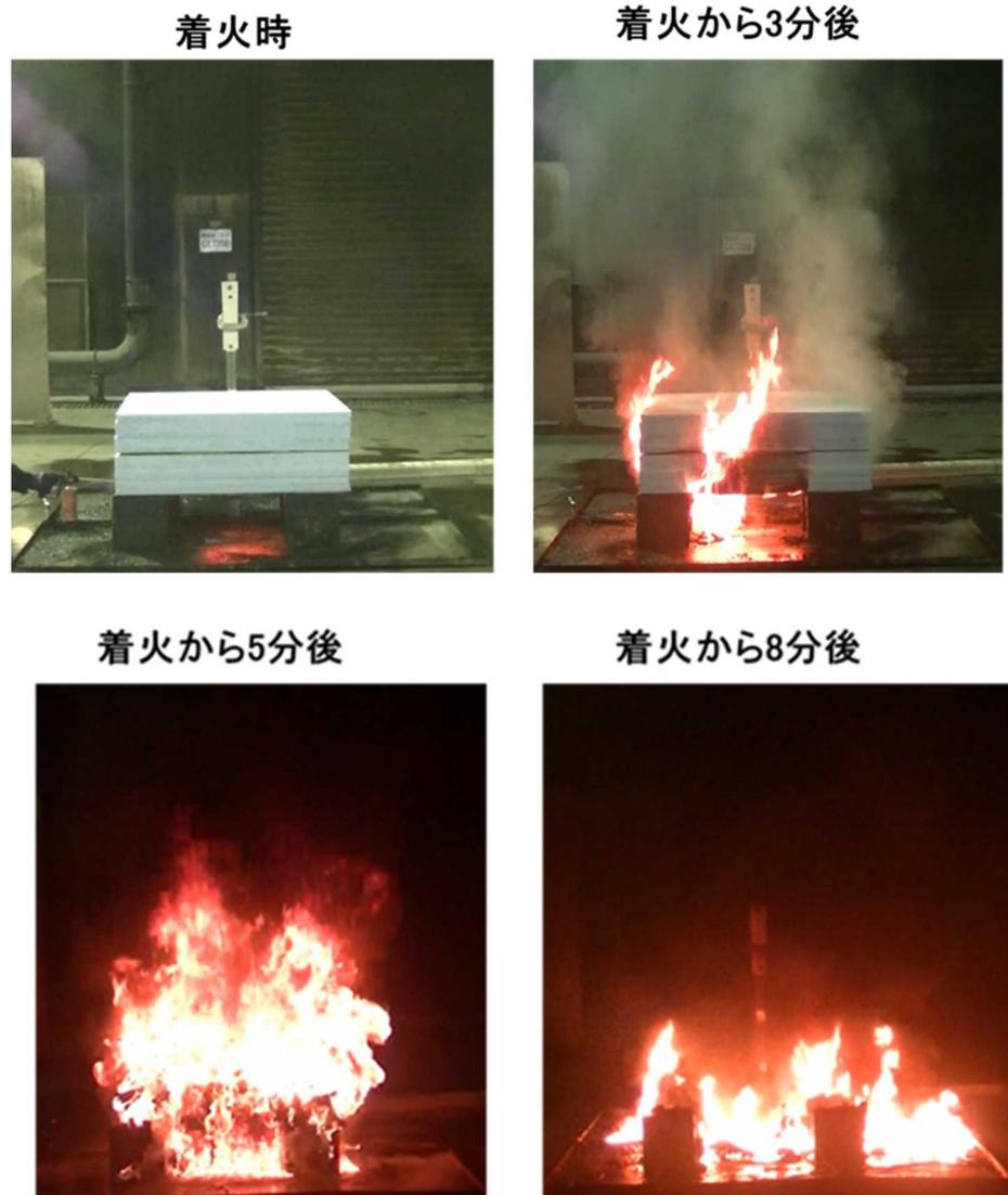
図 10 XPS火災再現実験の写真
