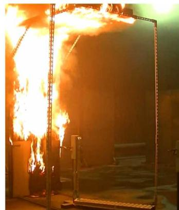
高さ2.7mの天井部分も激しく燃焼
