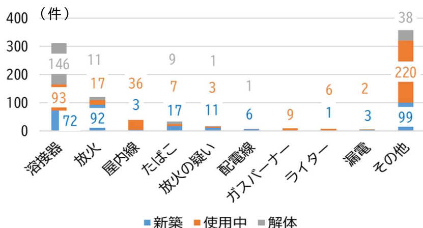
グラフ2-13 主な火災原因（上位10位） 建物工事種別
