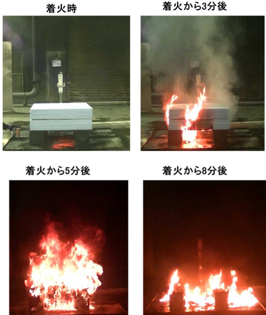
図10 XPS火災再現実験の写真
