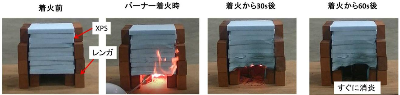
図4 堆積されたXPSの燃焼確認（段ボールなし）
