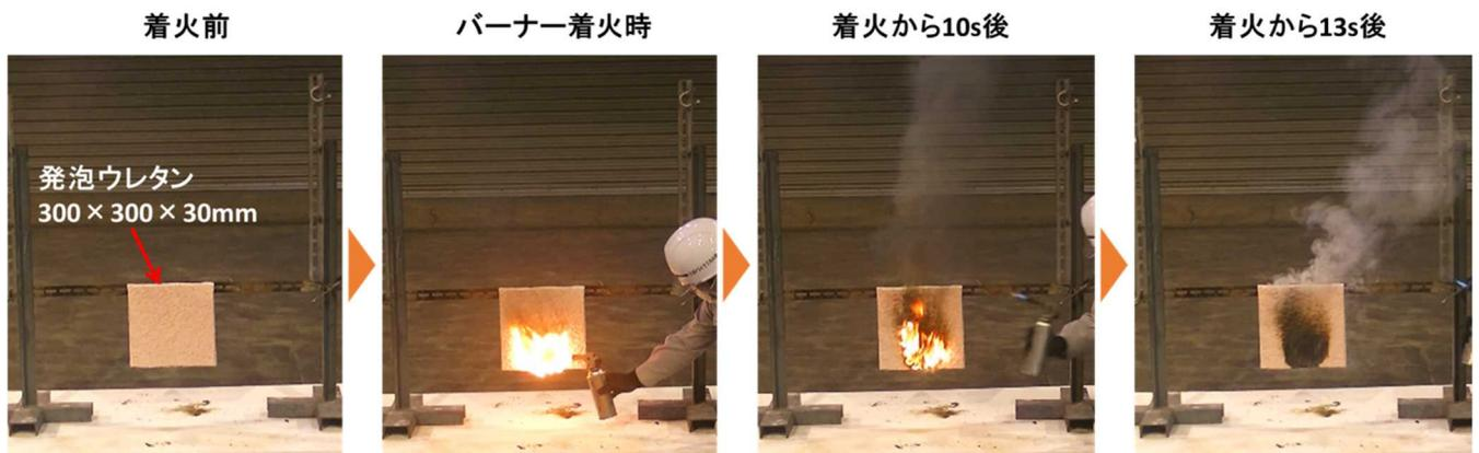
図6 発泡ウレタンテストピースの燃焼実験
