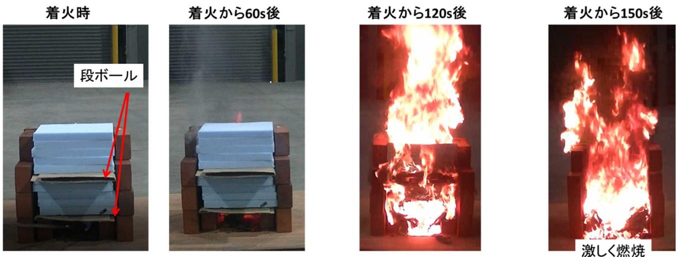
図5 堆積されたXPSの燃焼実験（段ボールあり）
