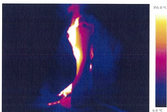
図5－10 サンプルB（シーズヒータ） 布団巻き付けサーモグラフィー
