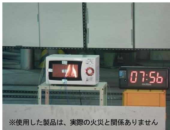
写真3 冷凍食品の燃焼状況
