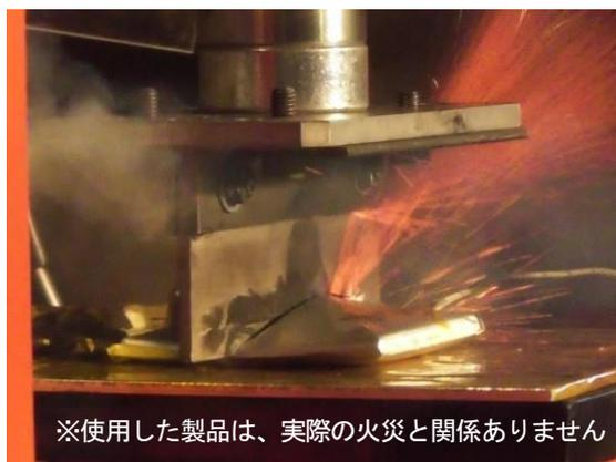
写真1 リチウムイオン蓄電池の圧壊状況
