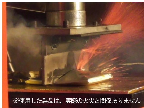
写真1 リチウムイオン蓄電池の圧壊状況
