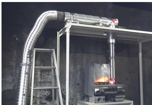
写真3-2 縦ダクト延焼状況
