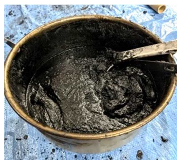
写真 4-8 ダクトに塗布する油脂
