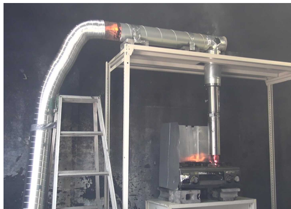
写真3-3 横ダクト延焼状況
