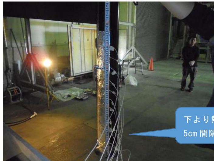
写真 5－5 ダクト外側の熱電対設置位置
