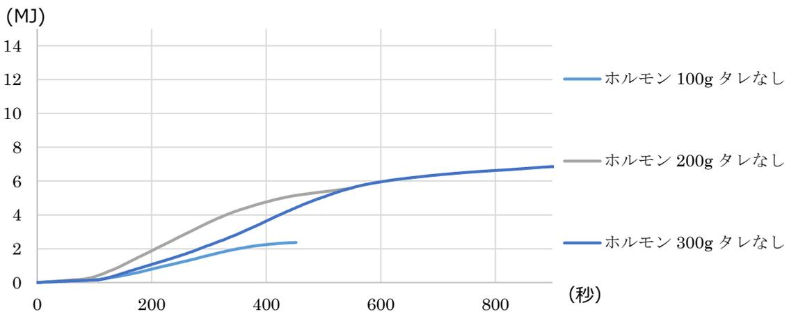
図 6-6 七輪小にてホルモン（タレなし、100g から 300g）を燃焼させたときの総発熱量
