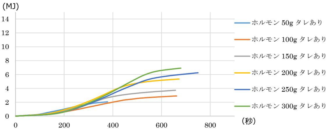
図 6-5 七輪小にてホルモン（タレあり、50g から 300g）を燃焼させたときの総発熱量
