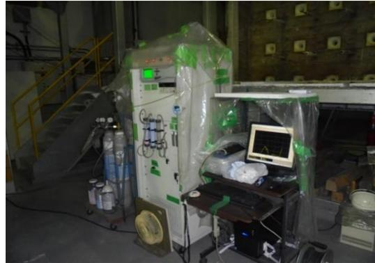
図6-2 二酸化炭素濃度測定器
