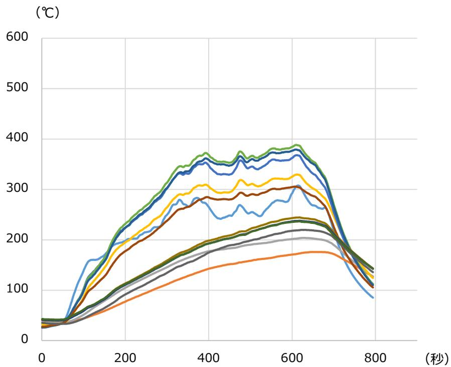
图 6 - 12 火皿 15cm 離隔距離 20cm 風速 3m/s
