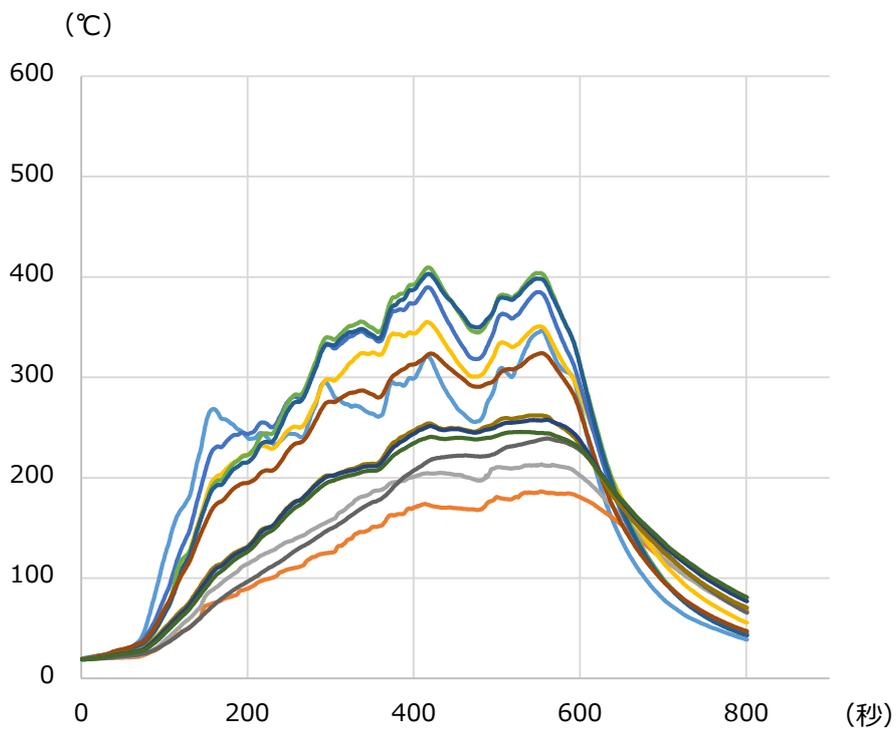
图 6 - 25 火皿 20cm 離隔距離 30cm 風速 5m/s
