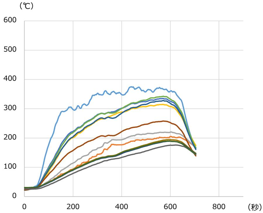
图 6 - 11 火皿 15cm 離隔距離 30cm 風速 3m/s
