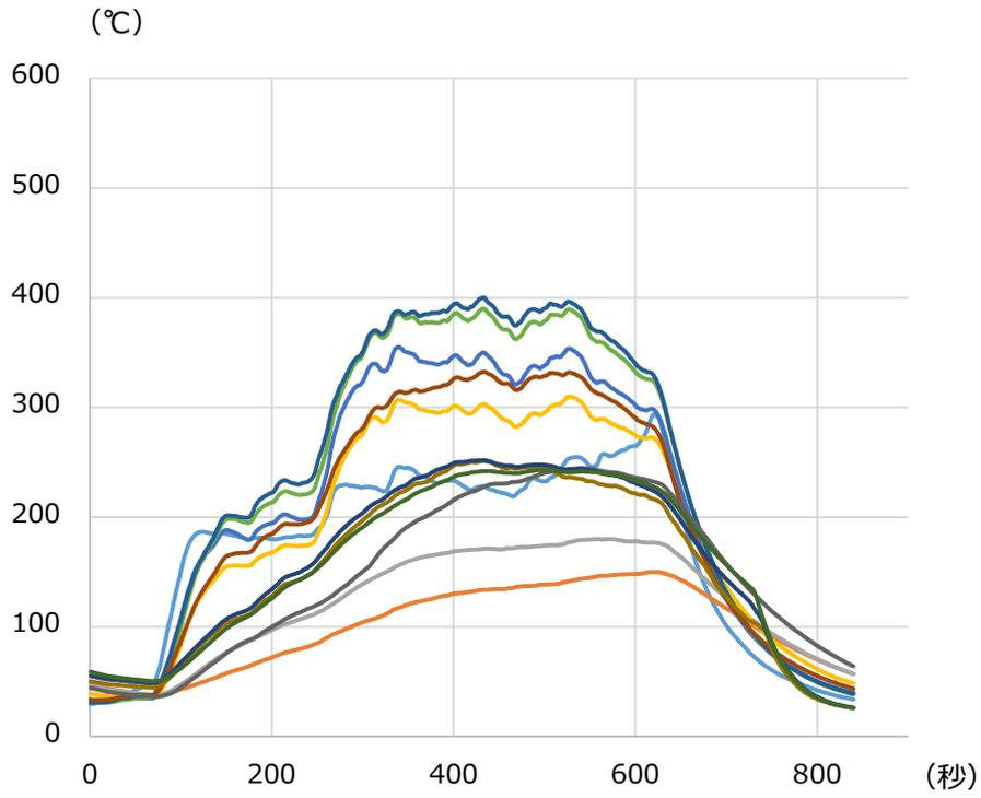
图 6 - 26 火皿 20cm 離隔距離 20cm 風速 5m/s
