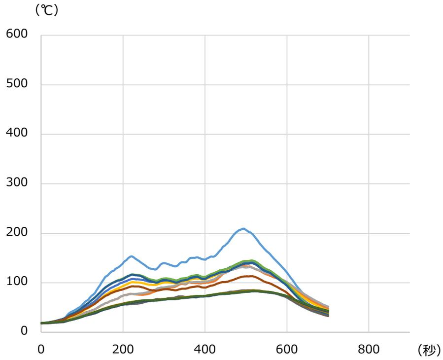
图 6 - 17 火皿 15cm 離隔距離 50cm 風速 7m/s
