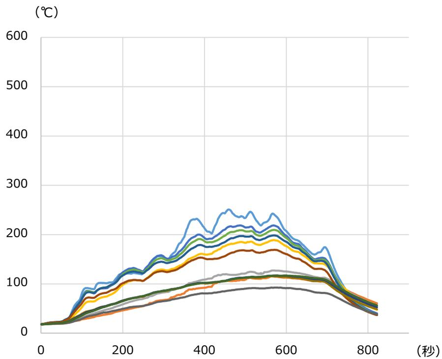
图 6 - 14 火皿 15cm 離隔距離 40cm 風速 5m/s
