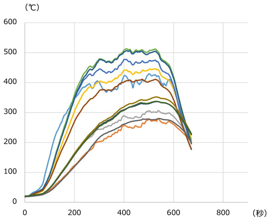
图 6 - 23 火皿 20cm 離隔距離 50cm 風速 5m/s
