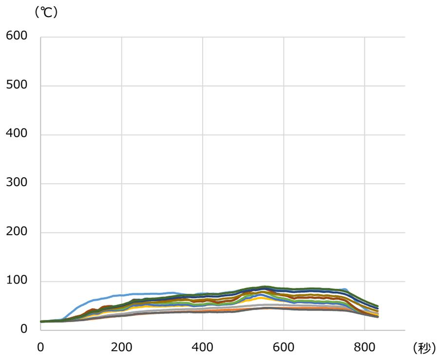
图 6 - 20 火皿 15cm 離隔距離 20cm 風速 7m/s
