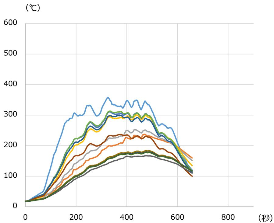
图 6 - 21 火皿 20cm 離隔距離 40cm 風速 3m/s
