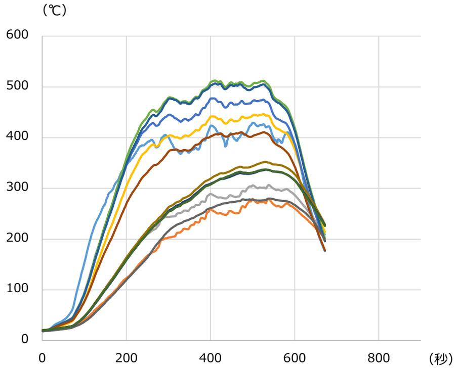
图 6 - 22 火皿 20cm 離隔距離 30cm 風速 3m/s
