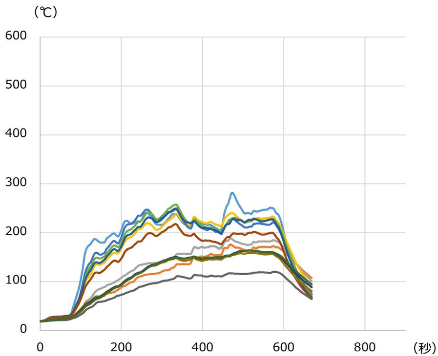
图 6 - 29 火皿 20cm 離隔距離 30cm 風速 7m/s
