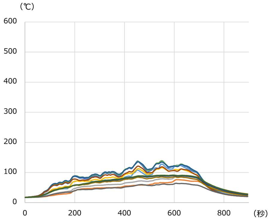
图 6 - 18 火皿 15cm 離隔距離 40cm 風速 7m/s
