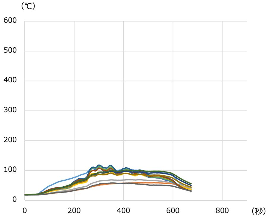
图 6 - 19 火皿 15cm 離隔距離 30cm 風速 7m/s
