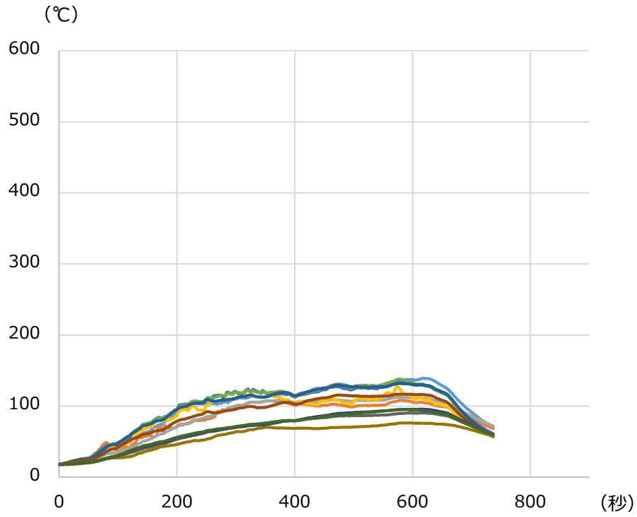
图 6 - 13 火皿 15cm 離隔距離 50cm 風速 5m/s
