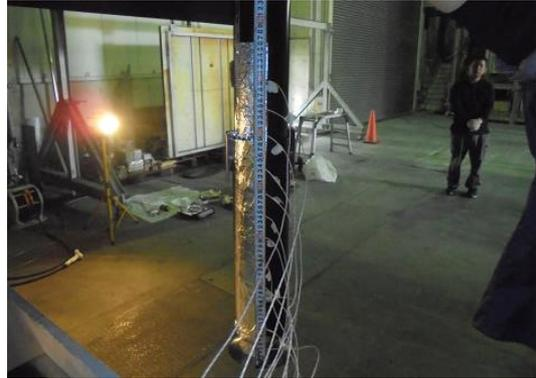
写真6-47 上引きダクト外部へ熱電対設置
