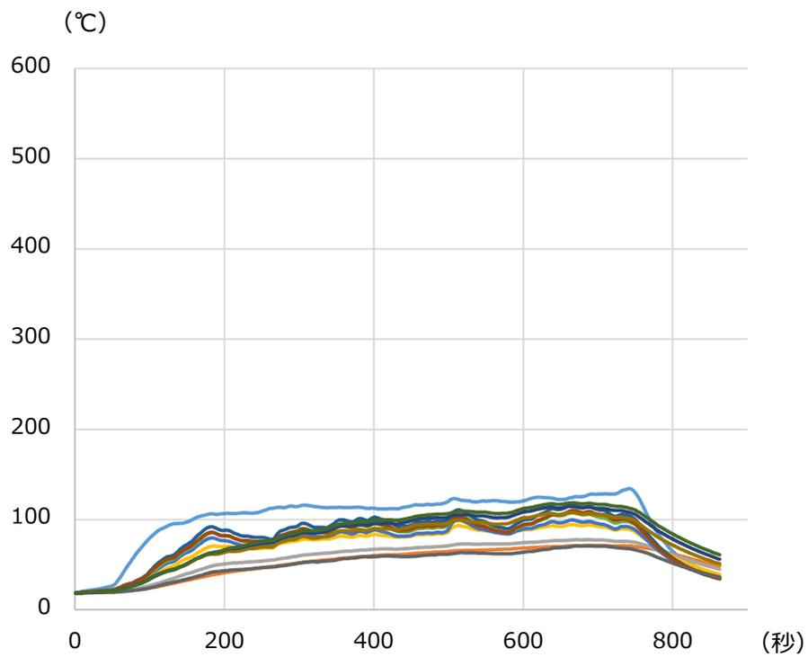
图 6 - 16 火皿 15cm 離隔距離 20cm 風速 5m/s
