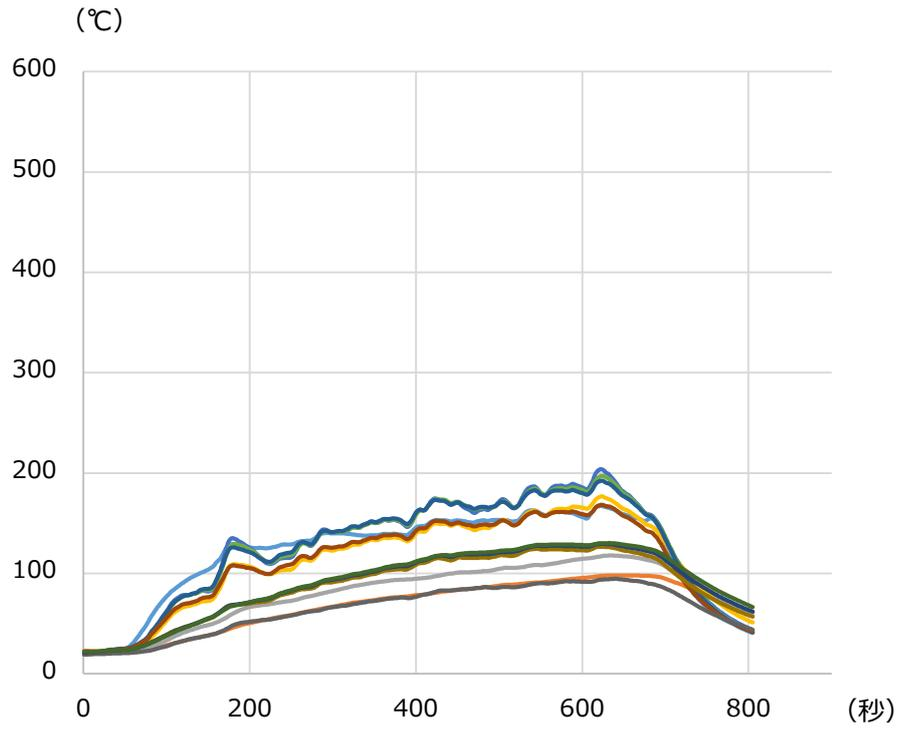
图 6 - 15 火皿 15cm 離隔距離 30cm 風速 5m/s
