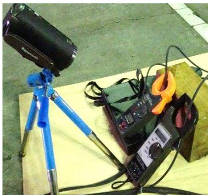
写真 6-8 電流測定状況
