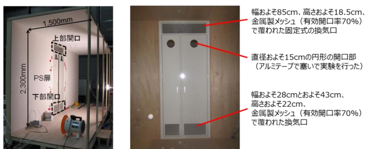
図 2.2.3-2 パイプシャフト設置状況
