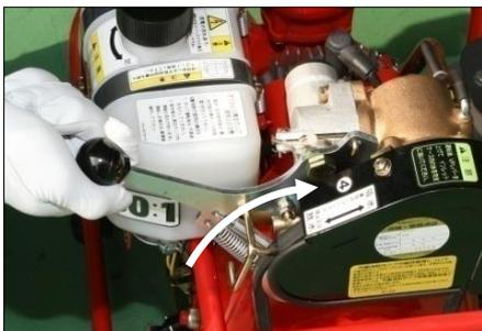
①吸水レバーを「吸水」側に操作します。
