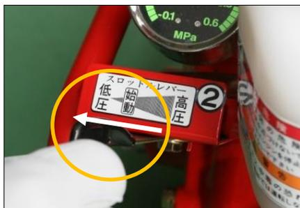
①放水側からの放水停止の合図を確認したら、スロットレバーを低圧にします。
