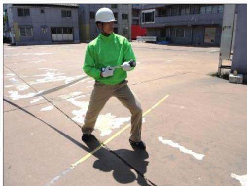
②水圧による反動力でバランスを崩さないよう、放水が終わるまでしっかりと保持します。管そうは目標に向け、腰の位置でしっかりと保持します。前傾姿勢を取り、反動力を抑えましょう。
