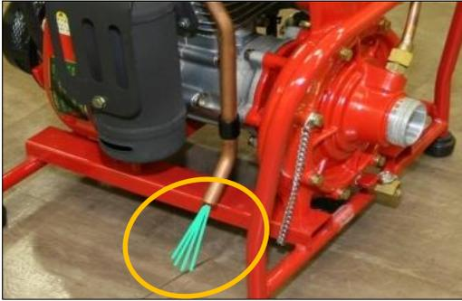
②真空ポンプ排水パイプから水が連続的に出るのを確認し、吸水レバーを元の位置に戻します。水が出ていれば吸水できています。
