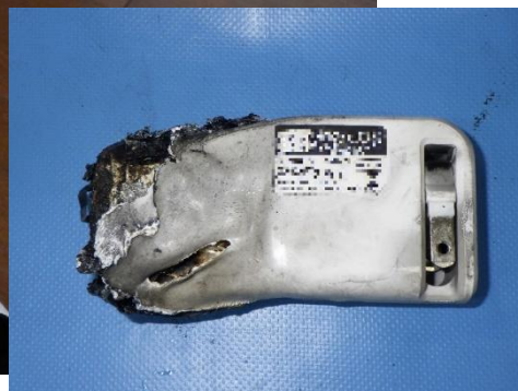
⑩充電中のモバイルバッテリーが 電池内部で短絡して出火した火災（９月）
