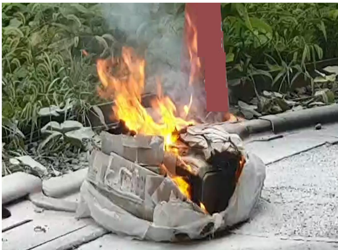
②可燃ごみとして廃棄された ポータブル電源から出火した火災（10月）
