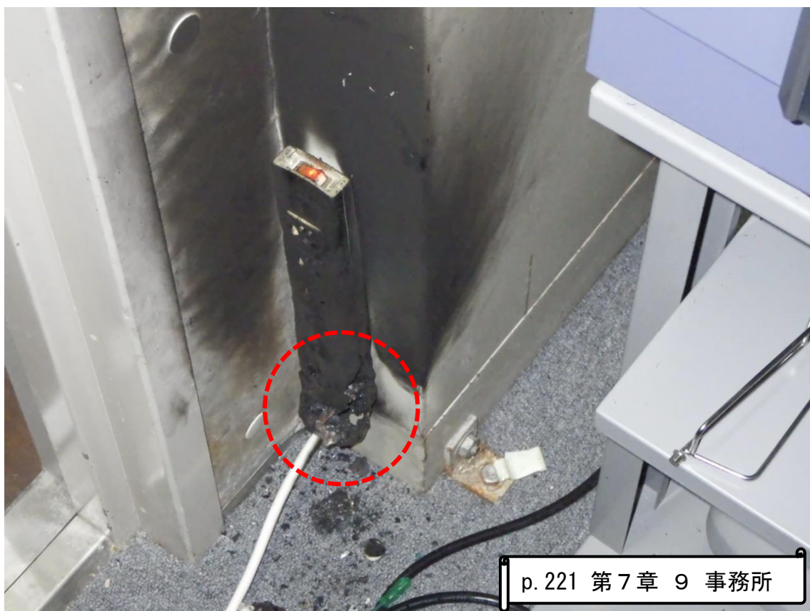
②テーブルタップのトラッキング により出火した火災（8月）
