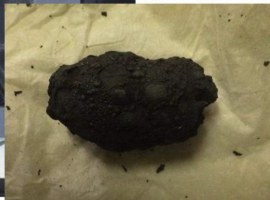
⑦電子レンジでさつまいもを 長時間加熱したため出火した火災（6月）
