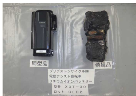
写真 13-2 焼損したバッテリーの状況
