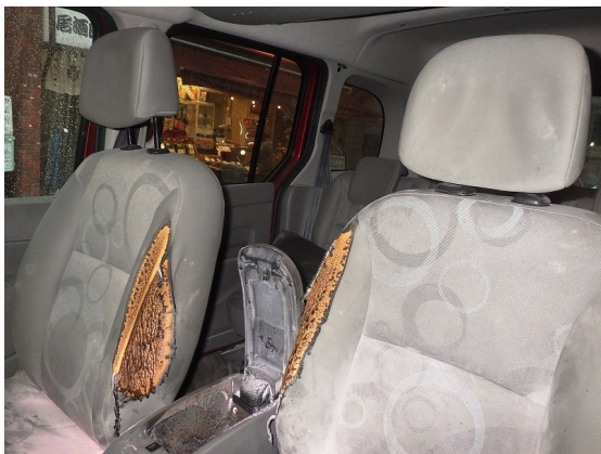
写真 4-3 焼損したフロントシートの状況
