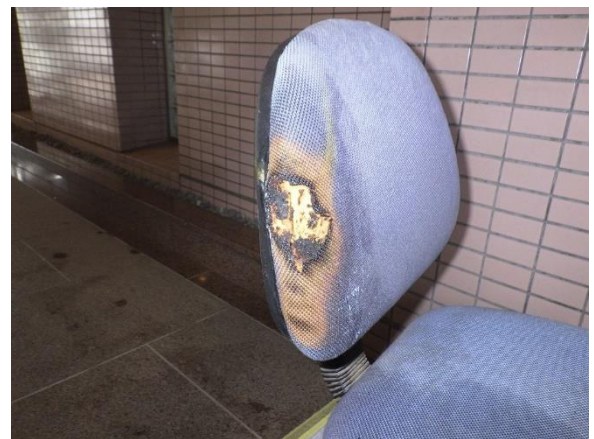
写真 6-8 焼損した椅子の状況
