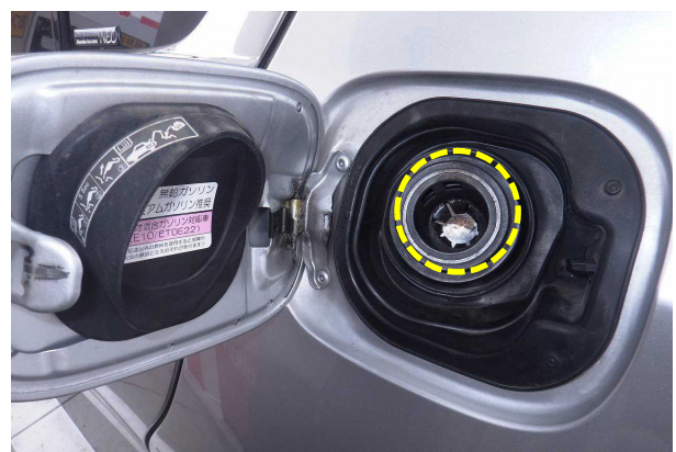
写真 28-4 給油口の焼損状況
