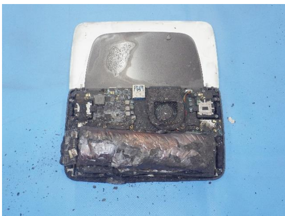
写真 6-5 モバイルパソコンの焼損状況
