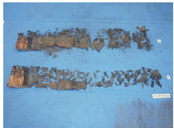
写真 6-6 焼損したバッテリーの状況
