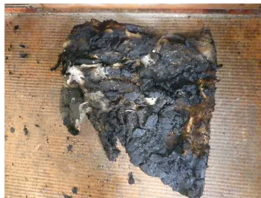
写真 14-5 座布団の焼損状況
