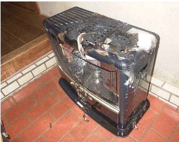
写真 8-3 焼損した石油ストーブの状況
