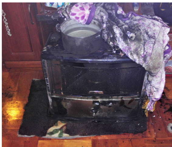
写真 8-1 石油ストーブの焼損状況
