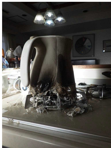
写真 15-2 焼損した電気ケトルの状況
