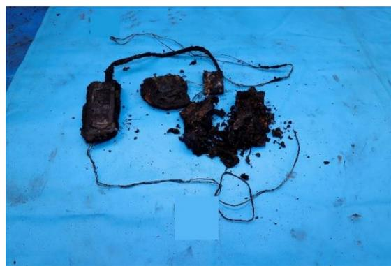
写真6 バッテリーの焼損状況
