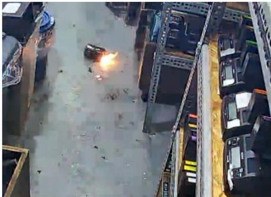
写真9 バッテリーの焼損状況
