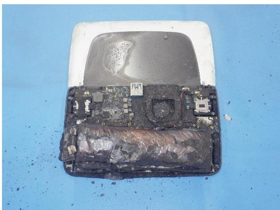
写真3 モバイルパソコンの焼損状況
