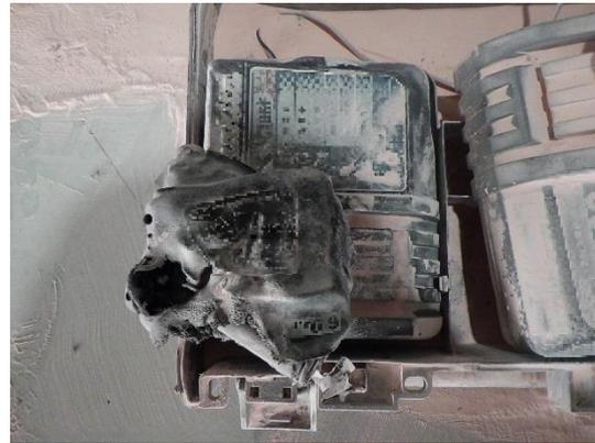
写真8 バッテリーの焼損状況
