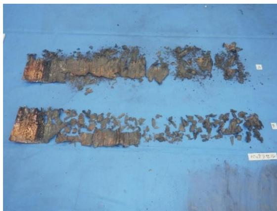
写真4 バッテリーセルの焼損状況
