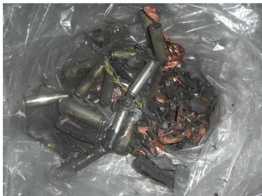
写真11 バッテリーの焼損状況
