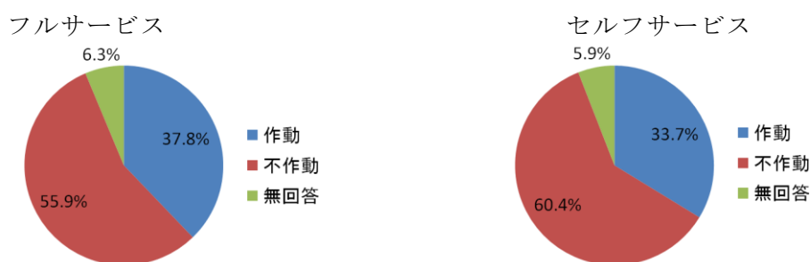
図 5-2 感震器の作動状況
