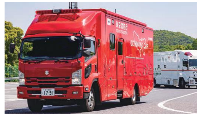
▲通信機器や作戦スペースを設けたコマンドカー
