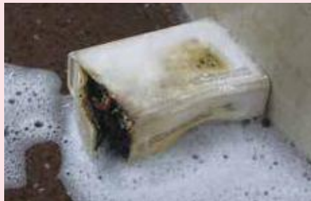
乗車中、モバイルバッテリーで、 スマートフォンを鞆に入れたまま充電 していたところ、 出火 しました
