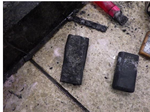
写真2 モバイルバッテリーの焼損状況
