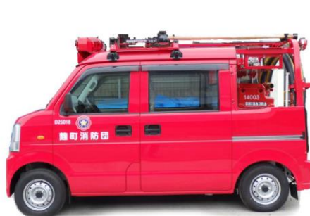
可搬ポンプ積載車
