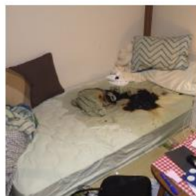
寝たばこにより火源が落下し 布団に着火した火災
