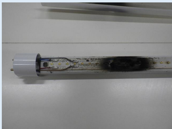
直管型LEDランプの焼損例
