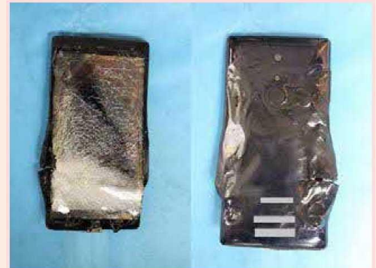
衝撃で破損したリチウムイオンバッテリー
